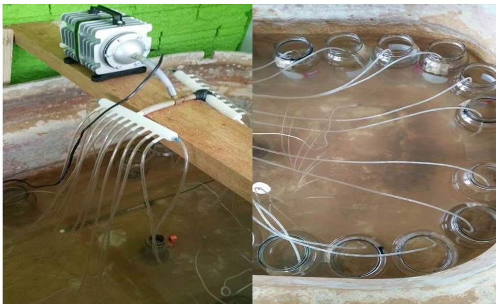
Figura 3. Sopradores para aeração dos recipientes.
