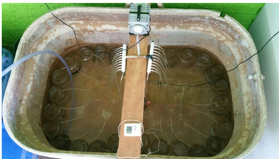
Figura 2. Caixa de amianto preparada com os recipientes, aquecedores e sopradores.
